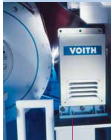
Рис. 2: Замер состояния сукна
